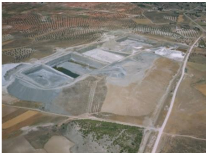
S.A.U. Sulquisa. Explotación a cielo abierto con minería de transferencia.
